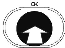
Der Eingabeknopf hat eine Tastfunktion, d.h. er kann gedrückt werden. Dies dient zum Auswählen des gerade angezeigten Parameters zur Änderung, bzw. zum Bestätigen eines blinkenden Wertes oder dem Zugang zu einer untergeordneten Menüebene.
