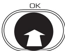
Der Eingabeknopf hat eine Tastfunktion, d.h. er kann gedrückt werden. Dies dient zum Auswählen des gerade angezeigten Parameters zur Änderung, bzw. zum Bestätigen eines blinkenden Wertes oder dem Zugang zu einer untergeordneten Menüebene.
