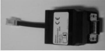
Die Parametrier- und Konfigurationsdaten eines Reglers sind mit dem Parameter-Speichermodul speicher- und auslesbar.
