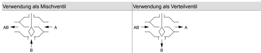
Die Regelventile BQE zeichnen sich durch hohe Zuverlässigkeit und Präzision aus und tragen einen wichtigen Beitrag zur umweltfreundlichen Regelung bei. Sie erfüllen anspruchsvolle Anforderungen wie Schnellschliessfunktion, Differenzdrücke bewältigen, Mediumtemperatur regeln und dies alles in geräuscharmer Form.
