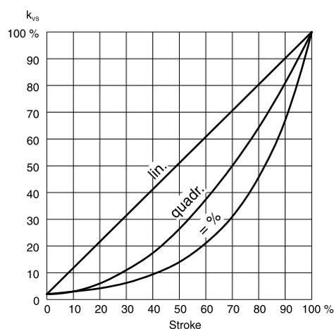
Kennlinienverlauf bei Verwendung am Antrieb AVM 322(S), AVM 234S, AVF 234S oder PLUS 2G.
