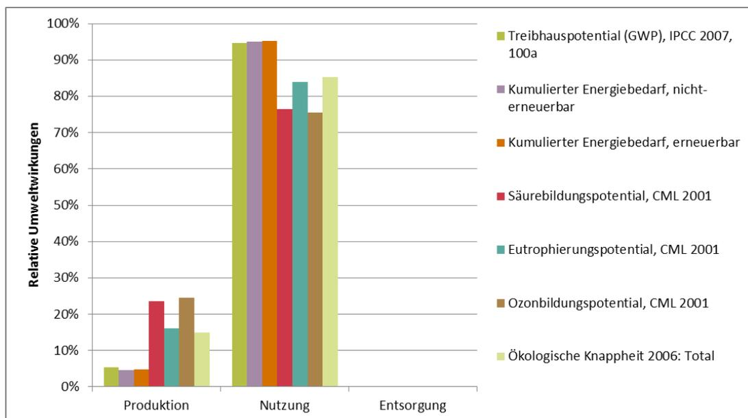
Das Verhältnis der Beiträge der Nutzung im Vergleich zu jenen der Reduktion und Entsorgung ist abhängig von der Intensität der Nutzung (Anwendungsszenario).
